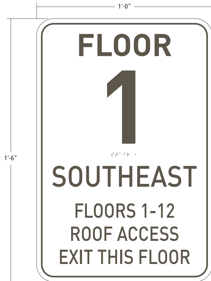
Sign Type H.1 - Stairwell Level Indicator | Scale: 3" = 1'-0"
