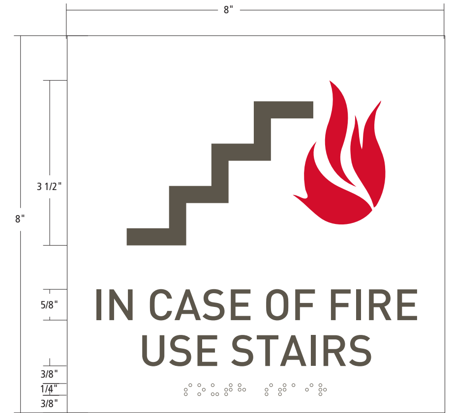
Sign Type B-2 - Stairwell | Scale: 1:2
