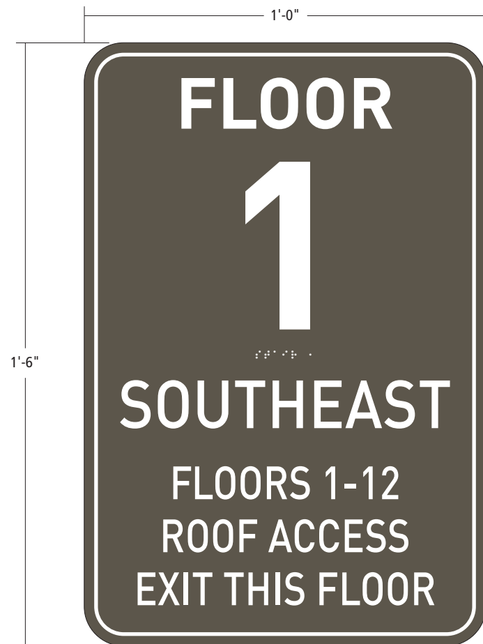
Sign Type H.1 - Stairwell Level Indicator | Scale: 3" = 1'-0"
